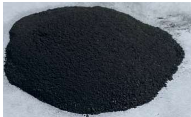
Рис. 1. Вид шлака, образующегося из печи Ванюкова (плавка в жидкой ванне), до дробления (а) и после дробления (б).
