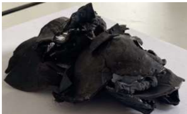
Рис. 3. Вид шлака, образующегося из печи КФП (кислородно-факельная плавка), до дробления (а) и после дробления (б).
