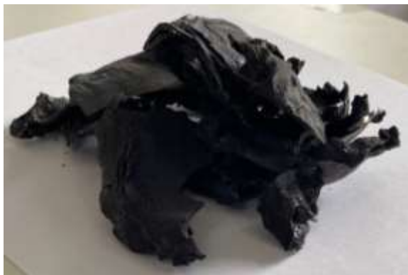
Рис. 1. Вид шлака, образующегося из печи Ванюкова (плавка в жидкой ванне), до дробления (а) и после дробления (б).
