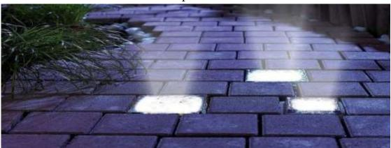
Охранное освещение: Применяется для освещения периметра участка, а также тех мест, которые должны находиться под видеонаблюдением. Работая от сумеречных фотодатчиков или реле времени, охранное освещение создает эффект присутствия на участке людей.
